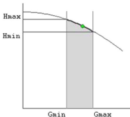
Рисунок 26. Напорно-расходная характеристика насоса
